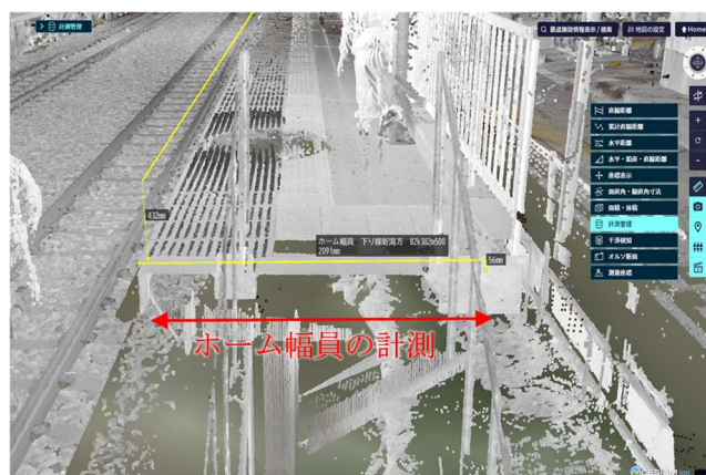
図-5 点群を用いた完成検査
