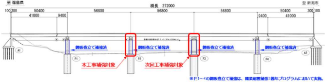
図-2 本工事による補強対象箇所
