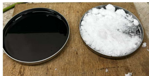
図-6 冷却中のアスファルトバインダー （左：自然冷却，右：雪冷却）
