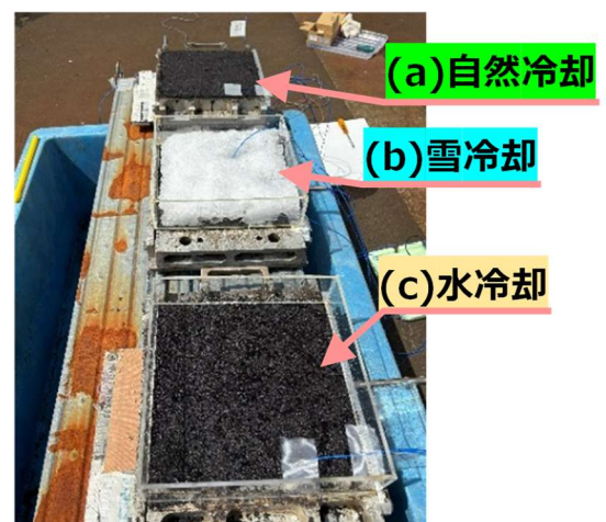
図-4 供試体を用いた冷却実験の様子
