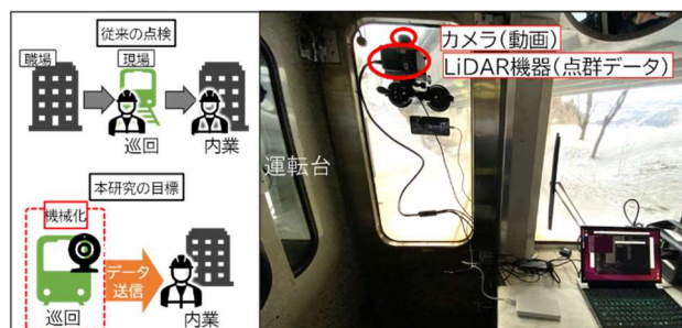
図 1 システム概要及び機器設置状況
