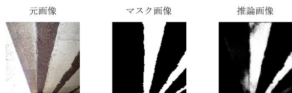
図-3 腐食の判定のイメージ
