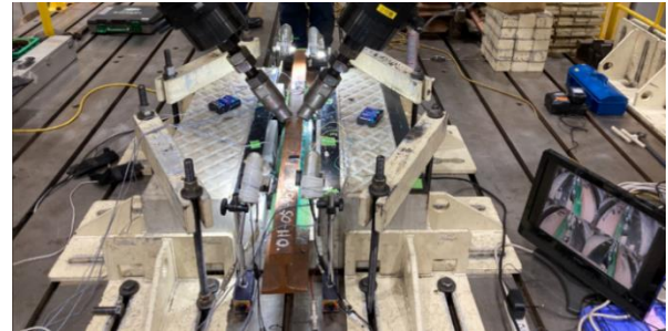
図3 二軸載荷試験状況
