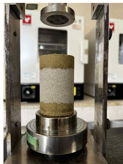
図1 セメント混合砂の供試体
