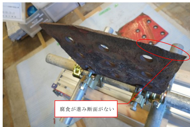
図-3 ガセットプレートの破断面
