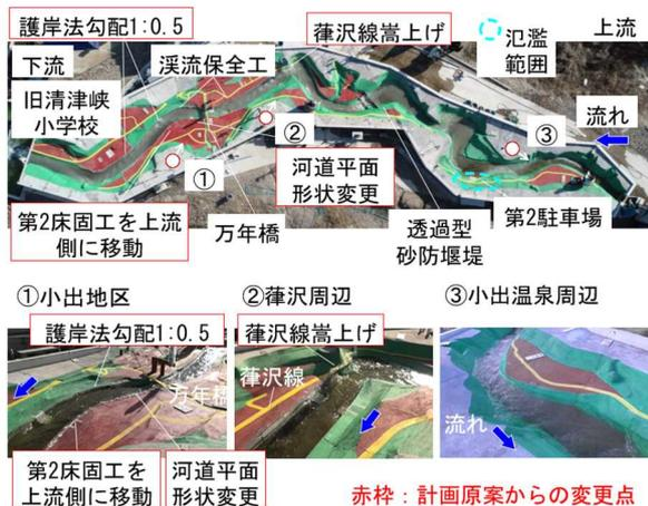
図 11 施設配置計画変更後の流況
