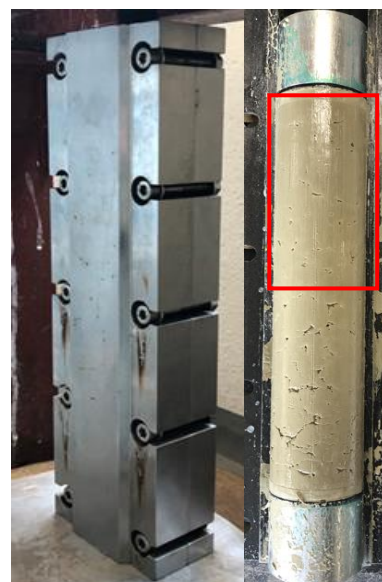
図1 円柱モールド及び圧密試料
