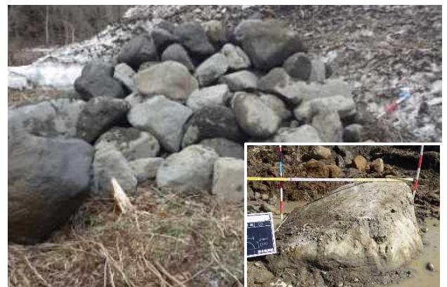
写真-2 地表面より掘り出された玉石
