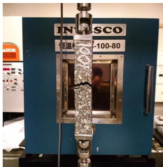
写真-2 直接引張試験の実施状況
