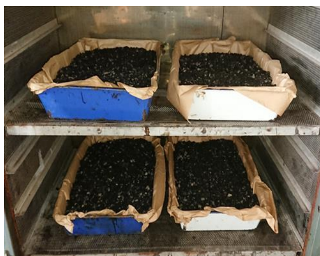
写真-1 再生骨材の加熱促進劣化状況
