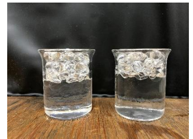
図2 屈折率マッチング (左:オイル 右:水)
