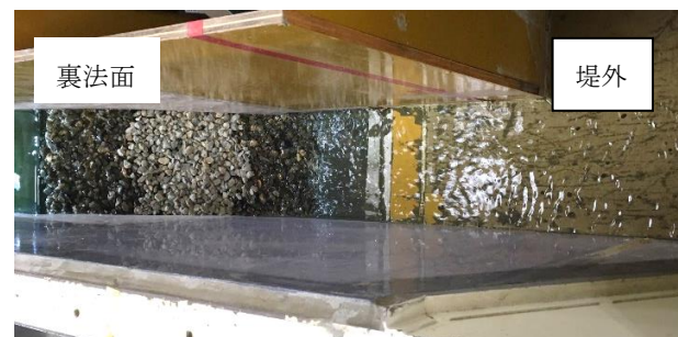
図-5 堤外に流出した越水（越流中）
