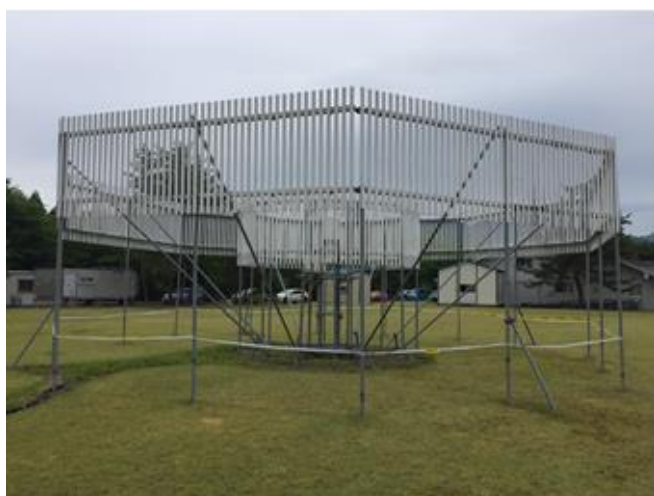
図-1 防災科学技術研究所雪氷防災研究センターの DFIR の外観
