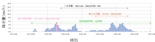
図-4 (a)横田切れ洪水と(b)~(d)近年の3洪水のハイトグラフ (小千谷地点流域平均雨量)
