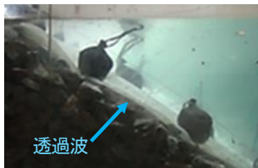
図-14 透過波によるトン袋模型の持ち上げ (case3-6)
