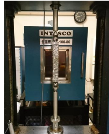
写真-1 直接引張試験の実施状況
