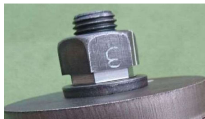
図2 ナット切削後 (下部)
