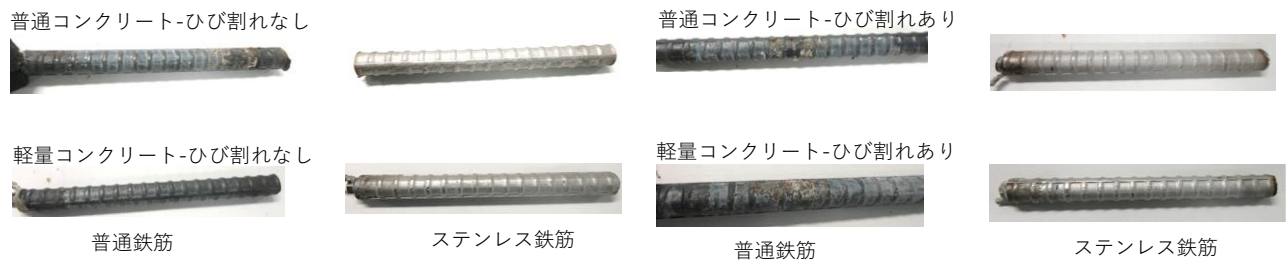
図-4 鉄筋の腐食状況
