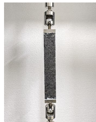
写真-1 直接引張試験の実施状況
