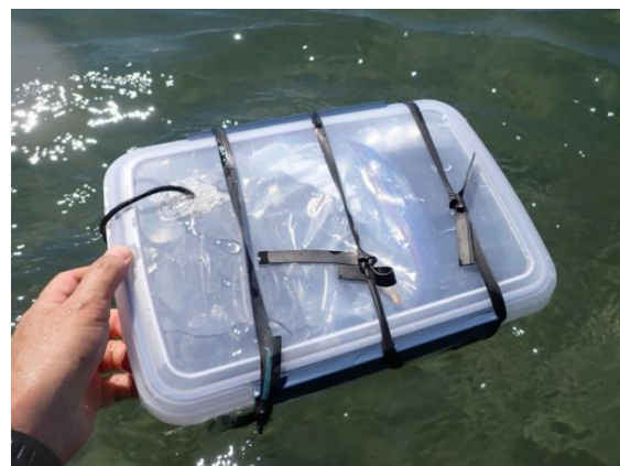
図-12 測深器使用状況
