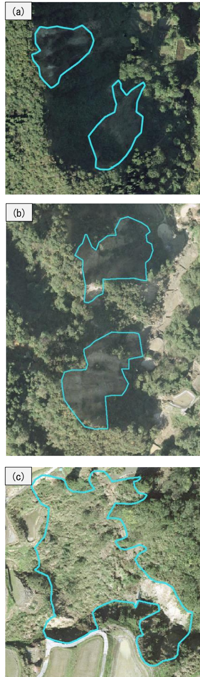
図-4 誤判別パッチが存在する崩壊地、水色線内が崩壊地
