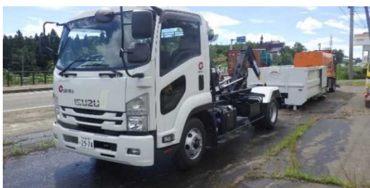
写真-12 アームロール式のダンプトラック
