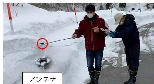
図-2 RTK 測位による積雪断面形状の計測の様子
