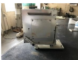
図-4 モールド組み立て ( 0^\circ と 45^\circ )
