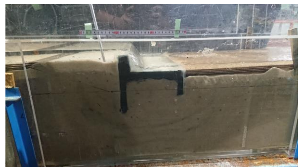
図 2 アルミパイプを差し込んだ水路断面図
