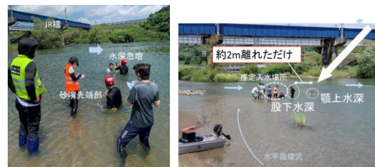
図-9 砂嘴先端部からの水深変化把握状況
