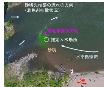
図-12 砂嘴先端部からの着色剤の拡散状況
