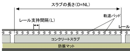
図-1 本研究の軌道モデル縦断面図
