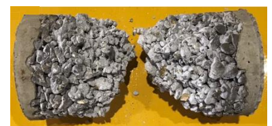
図 4 試験体破壊状況
