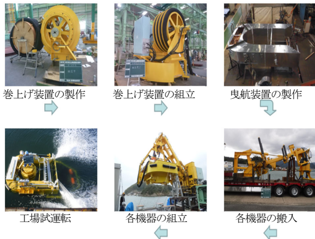
図-10 「改良型油回収器の製作過程」
