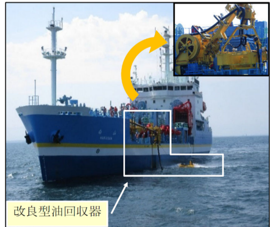
図-3 「白山に搭載した改良型油回収器」 (油回収訓練状況)
