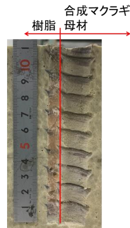
図 5 最大ねじくぎ引抜強さ計測直後断面
