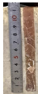
図 7 旧穴乾燥時樹脂充てん断面
