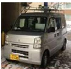
図-1 車載 LiDAR
