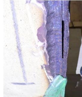
写真-1 すみ肉溶接部の腐食切れの一例
