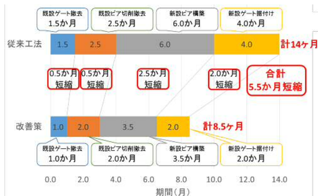
図-3 1号ゲート工事 工期短縮結果
