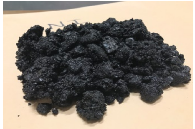
写真-2 混入率 15%配合の煮沸後の状況
