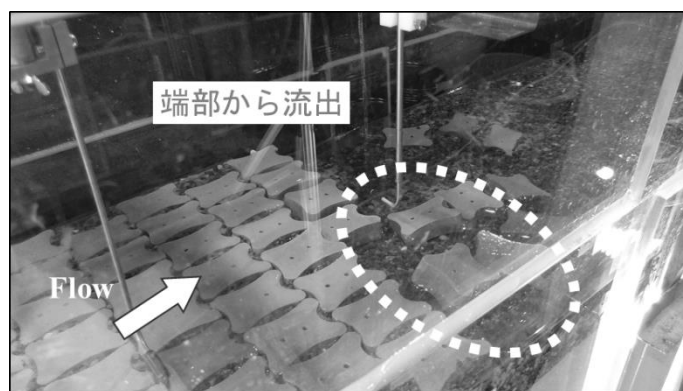
写真-3 ブロックの流出形態
