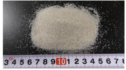
写真-1 地盤に用いた材料（東北珪砂5号）
